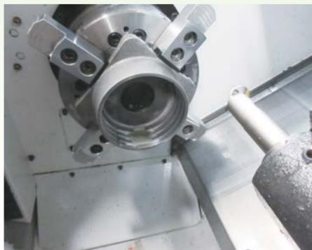
がいし金具など楕円や四角形のワーク用に4爪チャックを標準装備したNC旋盤も導入しています。
