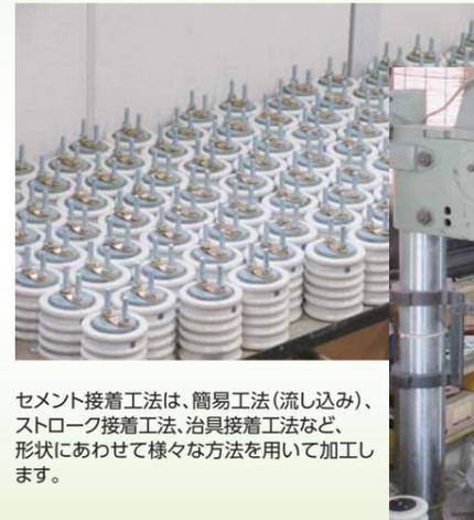
セメント接着工法は、簡易工法(流し込み)、ストローク接着工法、治具接着工法など、形状にあわせて様々な方法を用いて加工します。
