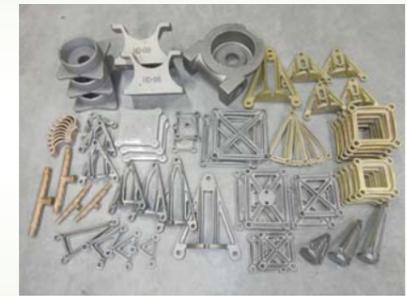
冷えて固まった金属を砂型より取り出し、砂を落とします。バリや湯口を削り取り、铸物製品(素材)の完成です。
